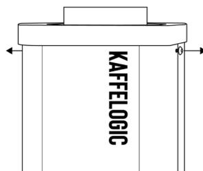
Entfernen Sie mit einem 2,5-mm-Inbusschlüssel die obere Schraube auf jeder Seite.
