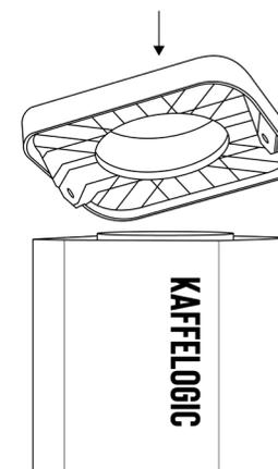
Setzen Sie den neuen Verschluss vorsichtig auf Ihr Gerät. Richten Sie die Schraubenlöcher des Verschlusses auf die Löcher in den Seiten aus.
