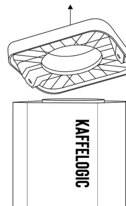
Heben Sie den oberen Verschluss vorsichtig ab und achten Sie darauf, dass Sie die Röstkammer nicht verschieben.
